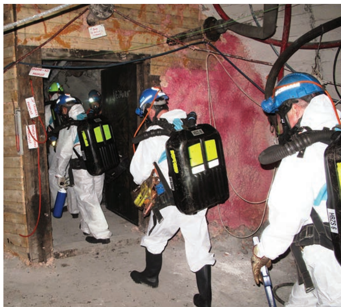
Začátek průzkumu – vstup do dusíkové propusti
