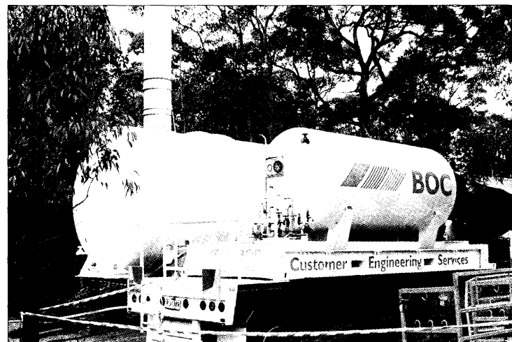
Mobilní odpařovací dusíková jednotka BOC v Austrálii, (foto Adamus 2005)
