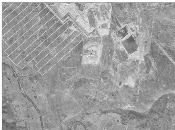
Obr. 3. Část dolu Beltana s vyznačenými porubními bloky.
