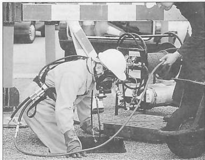
▲ PŘETLAKOVÝ HADICOVÝ DÝCHACÍ PŘÍSTROJ SIEBE GORMAN (NORTH) TYPU 85400 S HADICÍ AŽ 90 m DLOUHOU (odpovídá EN 139)
