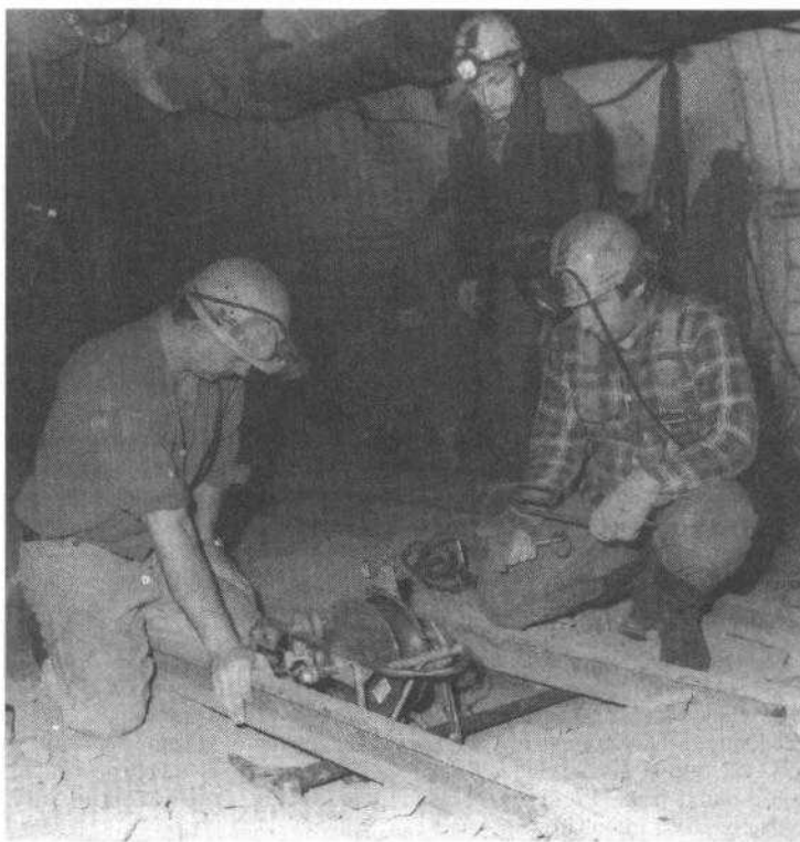
Ve dnech 29. 9. až 5. 10. 1993 profárali záchranáři - lezci s pomocí vrátku KENDLER větrní vrty o průměrech 1300 a 2360 mm o délce 92 a 180 m na dole Darkov. THr
