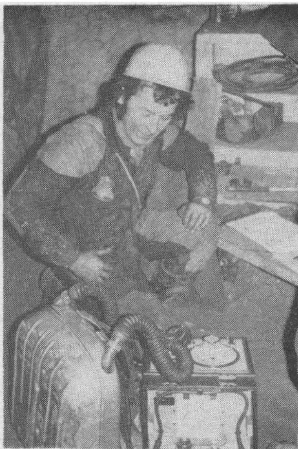
PŘI ROZSAHLEJŠÍCH AKCÍCH JE NA ZAKLADNĚ V DOLE VŽDY PŘÍTOMEN MECHANIK, KTERÝ ZKOUŠÍ TĚSNOST DÝCHAČÍCH PŘÍSTROJŮ A ZAJIŠTUJE DALŠÍ ÚKOLY
